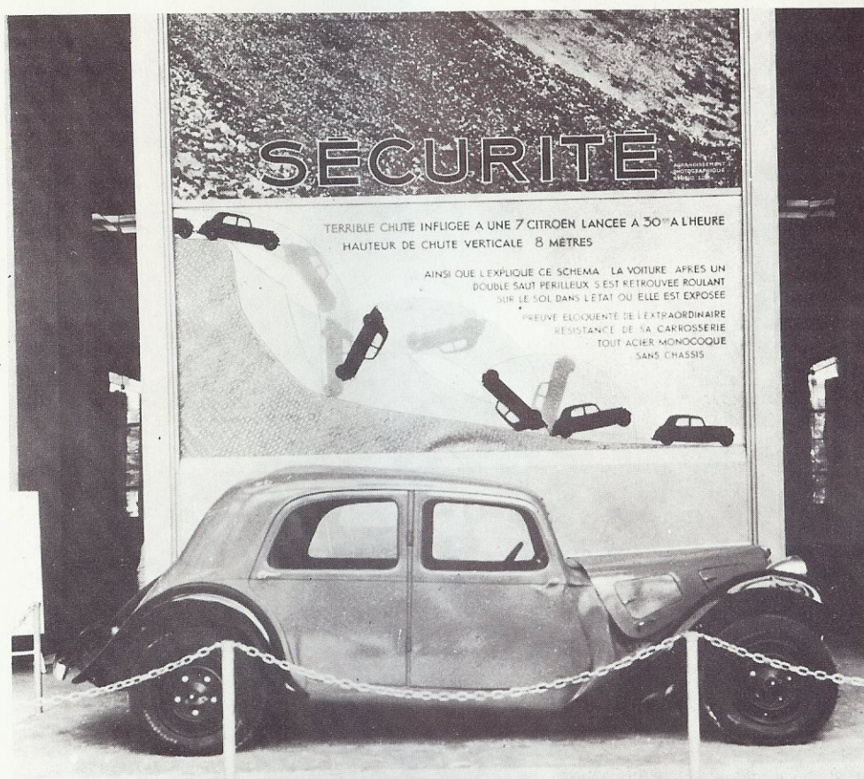
Ces photos montrent la chute que les techniciens Citroën firent effectuer à la Traction Avant pour prouver la solidité de sa carrosserie monocoque. La voiture fut ensuite exposée dans le hall d'exposition du quartier de l'Europe. Archives Citroën.
