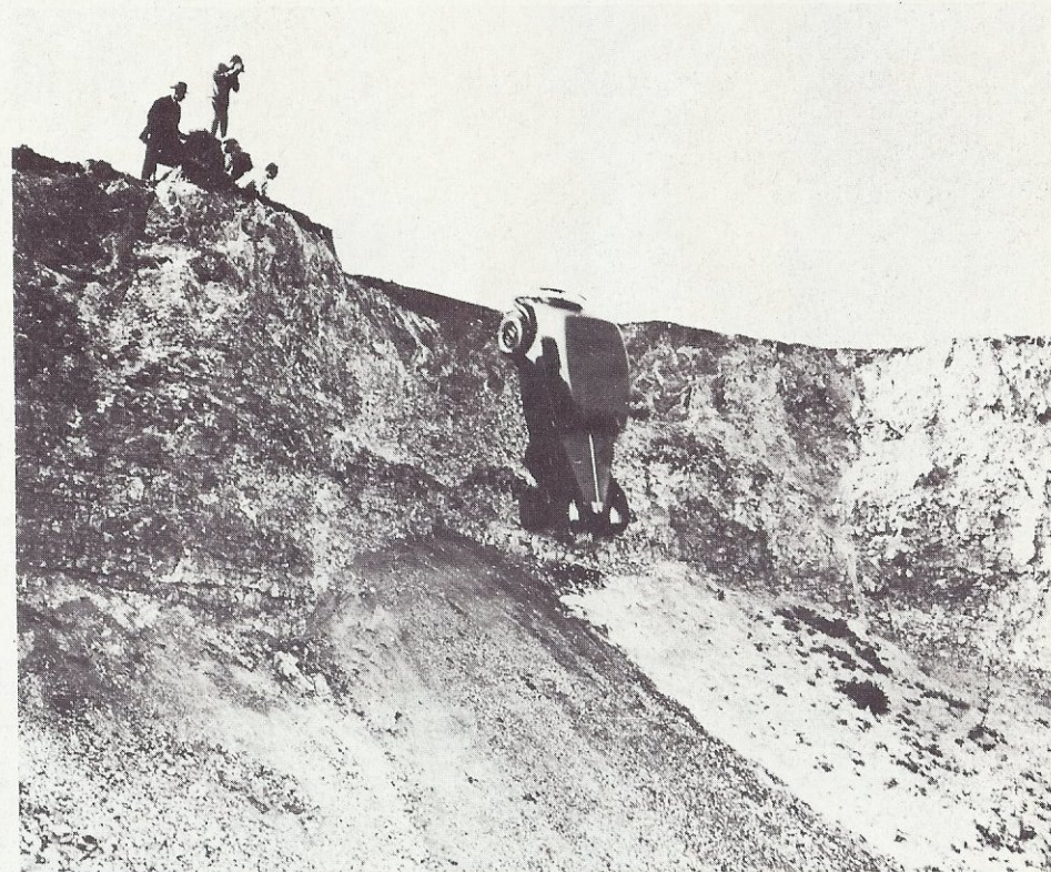
Ces photos montrent la chute que les techniciens Citroën firent effectuer à la Traction Avant pour prouver la solidité de sa carrosserie monocoque. La voiture fut ensuite exposée dans le hall d'exposition du quartier de l'Europe. Archives Citroën.
