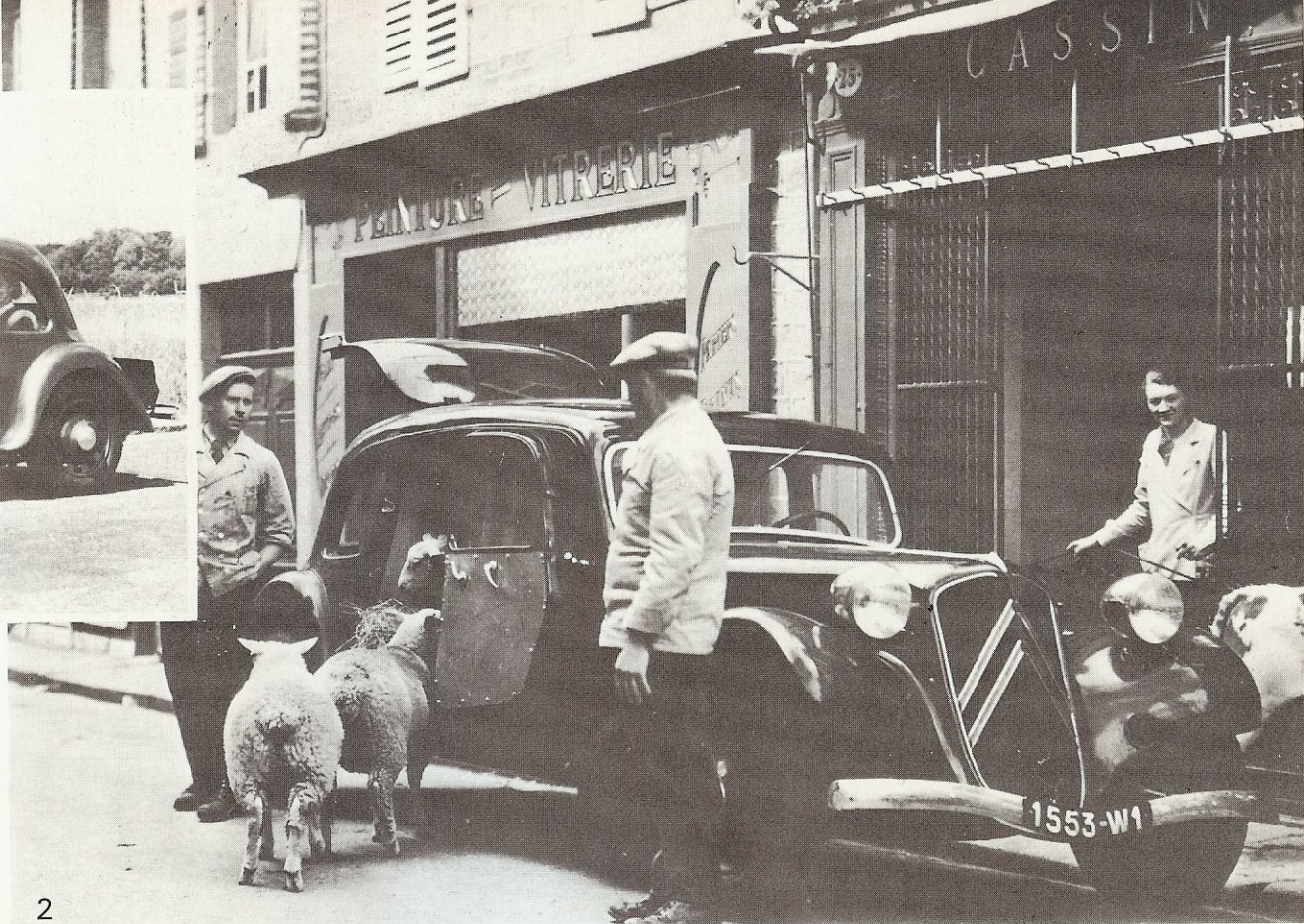
2 — Une "11 commerciale" lancée en octobre 1937, et arrêtée en septembre 1939, avant de reprendre de 1953 à 1957. Elle pouvait transporter 6 moutons de 50 kg ou 2 veaux de 100 kg, sans parler d'une quantité d'autres objets, dans ses 2 à 2,7 m3 suivant disposition du plancher. Elle était dite "tourisme-travail". Archives Citroën.
