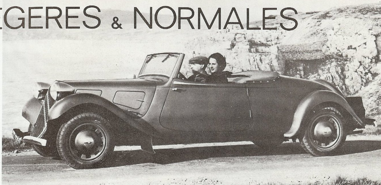
Le roadster-cabriolet "11 légère" décapoté, mais avec pare-brise relevé, tel qu'il était en 1938. Le passage de la manivelle y est allongé, et non rond comme à l'origine, pour permettre à la calandre d'être également montée sur la nouvelle "15". Archives Citroën.
