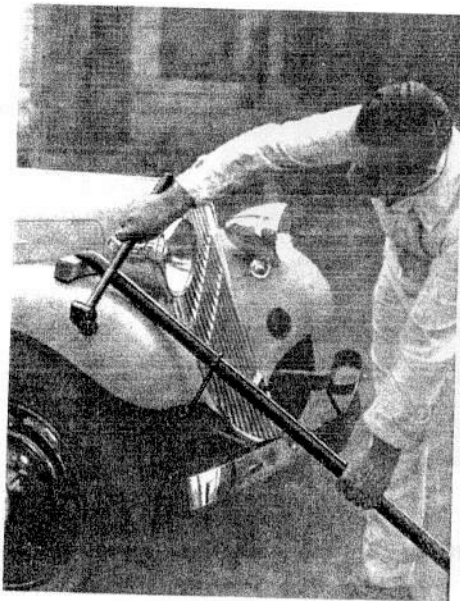
Fig. 4. — Débosselage d'une aile.
