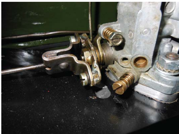
Weber 34 ICH throttle linkage modification
